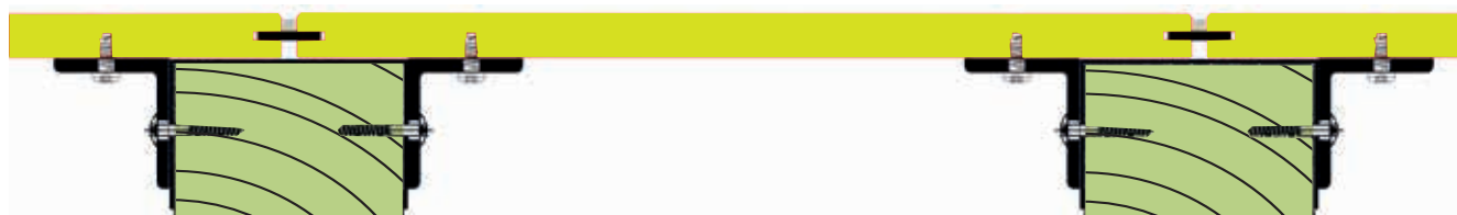
Balkonbodemplaat op houten draagbalken blind bevestigd (geschroefd)
